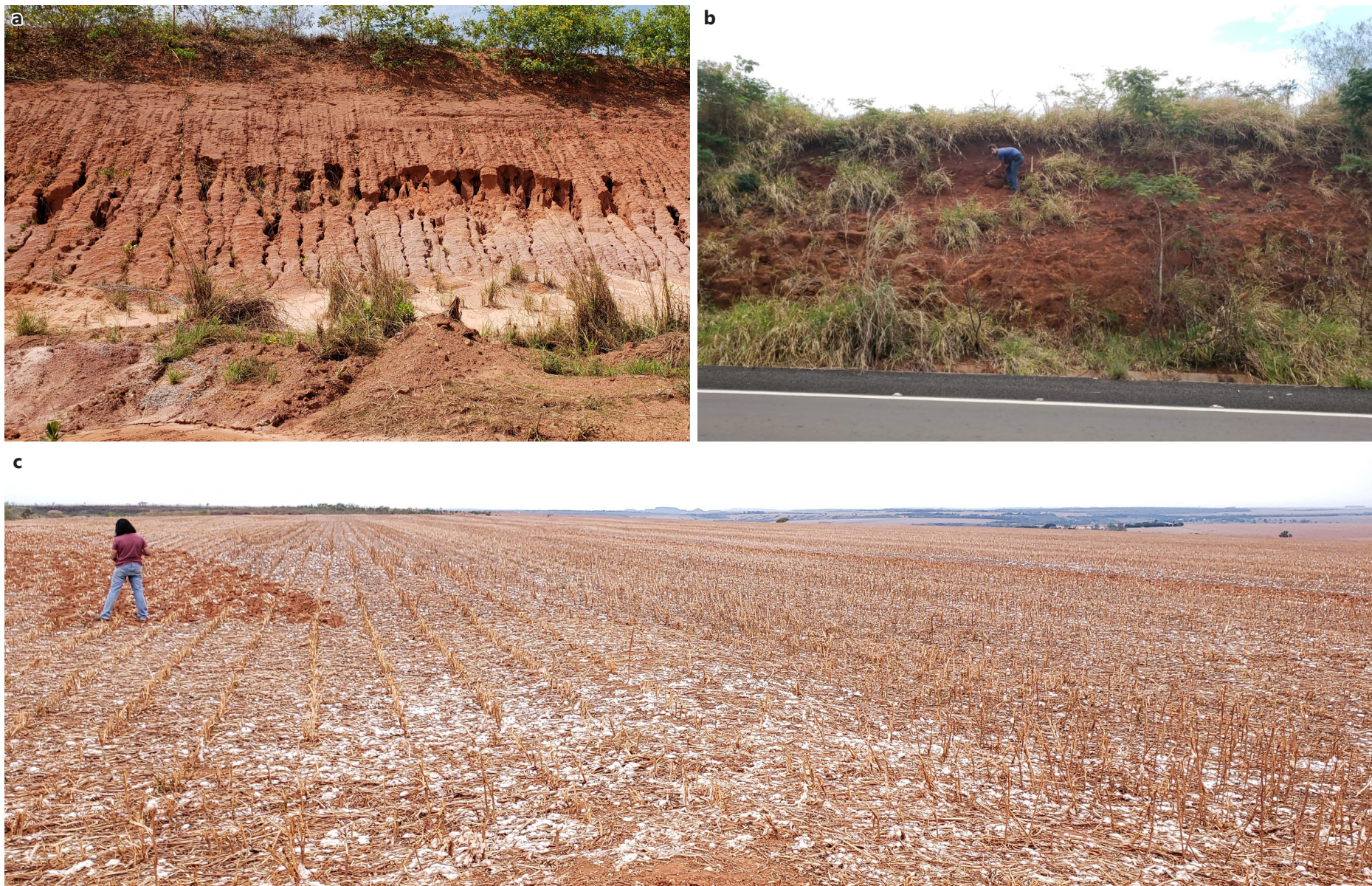
Figura 41 Imagens de perfis de solo documentados em campo: (a) perfil de Neossolo Quartzarênico em Torixoréu, MT (E= 335246 e N= 8217860); (b); perfil de Nitossolo na MT-100, entre os municípios de Alto Araguaia e Araguaína (E= 271731 e N= 8109452); (c) Latossolo Vermelho Amarelo nas proximidades de Guiratinga, MT (E= 256130 e N=8187432). SIRGAS2000, FUSO 22 S.
